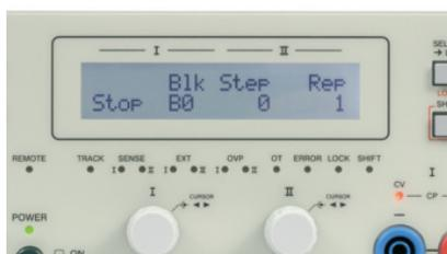
Anzeige des Sequenzablaufs mit Ausgabe des aktuellen Blocks, gerade ablaufendem Step und Anzahl der Bursts des aktuellen Blocks.
