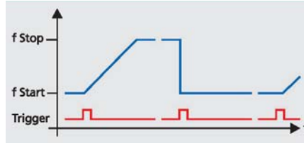
Getriggertes Sweep mit Hold und getriggertem Reset
